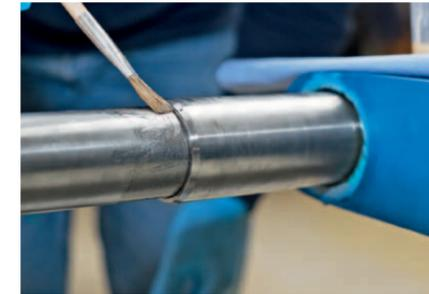
**5** **AUFGEKLEBT** Den Schaft an den Klebestellen mit Harz bestreichen. Die Hülsen beim Aufschieben hin- und herdrehen, damit sich das Harz gut verteilt. Die angeschrägte Seite gehört nach oben und erleichtert später das Einfädeln ins Lager. Überschüssiges Harz sofort abwischen
