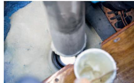
**3** **ABGEDICHTET** Bevor das Lager endgültig einlamiert wird, muss der Koker eingesetzt werden. Dazu wird er von außen mit etwas eingedicktem Harz bestrichen und ins Lagergehäuse gesteckt. Vorsicht: Es darf unter keinen Umständen Epoxid ins Innere des Lagers laufen
