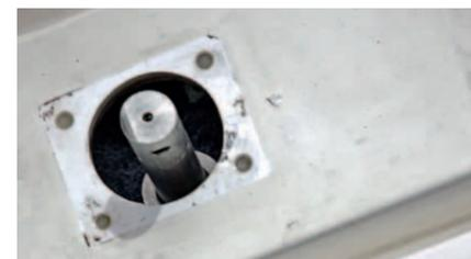
**3** **ANPROBIERT** Nun sollte das Ruder für eine Trockenprobe wieder eingesetzt werden. Darauf achten, dass Kiel und Ruder fluchten. Wenn die alten Löcher zentrisch geweitet wurden, muss der Schaft mittig im Deckschnitt stehen
