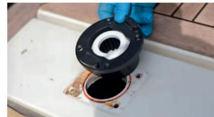
**1** **ANGEPASST** Wie das Unterhat auch das neue Oberlager einen größeren Außendurchmesser. Das macht Umbauten im Deck notwendig. Um den Durchbruch zu vergrößern, lohnt der Einsatz einer Lochsäge kaum. Anzeichnen und mit einer groben Raspel aufweiten geht ähnlich schnell
