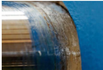
**2** **ABGENUTZT** Nicht nur die Lagerbuchse ist ausgeschlagen, auch der Ruderschaft selbst weist deutliche Tragspuren auf. Die Edelstahlwelle ist ungleichmäßig abgenutzt und nicht mehr rund. Für eine gute Passung muss eine neue Lagerfläche hergestellt werden
