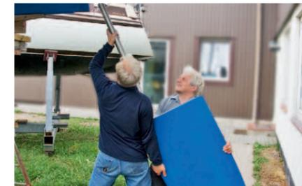
**1** **GEWICHTIG** Nachdem der Ruderkopf gelöst ist, kann das Ruder abgelassen werden. Achtung, auch ein Sandwich-Ruder wiegt leicht 50 Kilogramm oder mehr. Auflagen aus Holz und Pappe sollten vorbereitet sein. Für große Blätter mit einem Werkstatt-Wagenheber arbeiten
