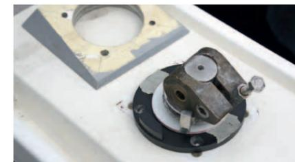
**4** **ANGEWINKELT** Weil der Ruderker zehn Grad geneigt ist, muss das obere Lager mit einem Keil unterfüttert werden. Gleichzeitig kann man so die Einbauhöhe des Lagers korrigieren, damit der Pinnenbeschlag passt und das Ruder nicht zu tief hängt
