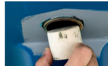
**4** **GEKLEMMT** Der Holzadapter sollte stramm in die alte Lagerbuchse passen. Notfalls helfen ein paar Lagen Klebeband. Wenn er nur wenig Spiel hat, kann man den Holzpflock auch einfach ins Wasser legen und eine Zeit lang aufquellen lassen
