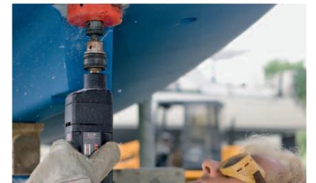
**5** **GEDULD** Die große Lochsäge erfordert eine sehr langsam drehende, leistungsstarke Bohrmaschine und viel Ausdauer. Das 30 Millimeter dicke Massivlaminat zu durchbohren, dauerte mit einigen Pausen fast eine Dreiviertelstunde
