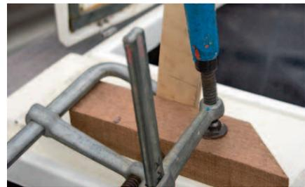
**4** **ABGESTÜTZT** Um weitermachen zu können, solange das Epoxid noch nicht ausgehärtet ist, wird der Koker von oben mit Holz abgefangen. Die Konstruktion muss so haltbar sein, dass sich der Koker auf keinen Fall bewegen kann
