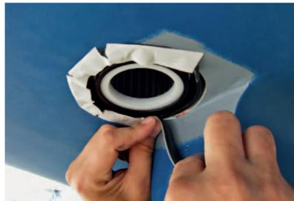
**2** **EINDICHTEN** Damit das Harz beim Einkleben nicht herausläuft, wird der Spalt zwischen Lager und Rumpf von unten abgedichtet. Dafür eignet sich sogenanntes Tacky-Tape, das als Dichtband für Vakuumsäcke verwendet wird. Es ist stark selbstklebend, lässt sich aber gut wieder entfernen
