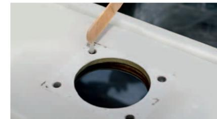
**2** **ANGEFÜLLT** Damit sich die alten und neuen Befestigungslöcher nicht ins Gehege kommen, werden die vorhandenen Bohrungen des alten Kopfbeschlages von Dichtungsresten befreit und anschließend unten mit Kleband verschlossen und mit angedicktem Epoxid aufgefüllt
