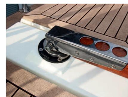
**4** **AUFGESETZT** Damit das obere Lager in Ruhe montiert werden kann, wird das Ruderblatt mit Böcken unterfüttert. Dann den Ausgleichskeil (inzwischen weiß lackiert) und das Lager mit Dichtungsmasse aufschrauben. Zum Schluss wird noch der Pinnenbeschlag montiert
