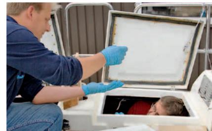
**6** **ANGEREICHT** Der nächste Schritt ist klebrig: Eine Person bleibt in der Achterpiek und laminiert, die andere reicht die entsprechend vorbereiteten Gelege von Oben an. Sicherheitshalber sollte das Deck abgeklebt werden. Epoxidharz lässt sich schlecht entfernen
