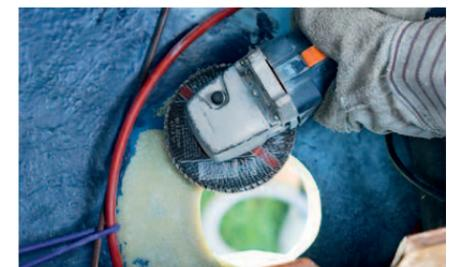
**8** **GESCHLIFFEN** Damit das neue Lager sicher fixiert werden kann, muss das Topcoat weggeschliffen werden. Dazu verwendet man am besten eine Flex mit Fächerschleifscheibe. Mindestens den anderthalbfachen Lagerdurchmesser als Klebefläche freilegen
