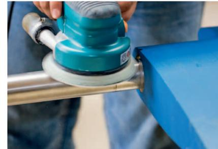
**4** **AUFGERAUT** Damit die Hülsen zuverlässig halten, muss der Ruderschaft an den Klebestellen mit 60er-Schleifpapier aufgeraut werden. Die Innenseiten der Hülsen besitzen spezielle Fräsnuten, damit sich das Harz gut verkrallen kann. Anschließend Schaft und Hülsen entfetten
