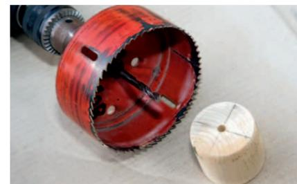
**3** **GEFÜHRT** Dazu bohrt man den Koker mit einer guten Lochsäge von unten aus dem Rumpf. So entsteht das Loch für das neue Lager. Zur Führung der Bohrkronen wurde hier ein Passstück aus Kiefernholz gedrechselt, alternativ tut es auch ein Leckpfropfen
