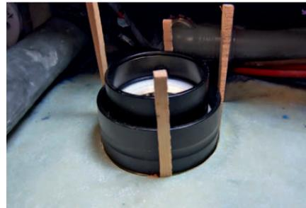
**1** **EINKLEMMEN** Die Kugelschale mit dem neuen Nadellager wird in den Rumpf gesteckt und mit dünnen Holzkeilen mittig fixiert. Da es sich um ein selbstausrichtendes Lager handelt, muss es nur grob mit der Ruderwelle fluchten und kann auch ohne Schaft eingeklebt werden
