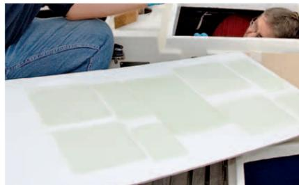
**5** **ANGERICHTET** Als Laminat wird 450 Gramm Biaxialgelege verwendet, da sich dieses noch gut an Rundungen schmiegen lässt. Um sicherzustellen, dass die Gelege vollständig mit Harz durchtränkt sind, werden die Laminatstücke vorgetränkt
