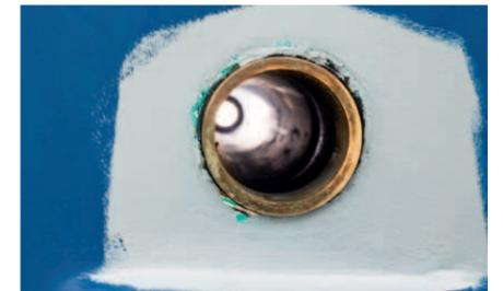
**2** **GEBRAUCHT** Blick von unten durch den alten Koker. Gut zu erkennen sind die obere und untere Lagerbuchse aus Bronze. Da die neuen Lager direkt im Rumpf sitzen und wesentlich größere Außendurchmesser haben, muss als Nächstes das Kokerrohr komplett entfernt werden
