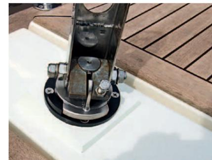
**3** **UMGEBAUT** Das neue Lager besitzt ins Gehäuse integrierte Ruderanschlüsse. Damit diese mit dem alten Pinnenbeschlag verwendet werden können, wurde ein Niroring angefertigt. Er hat eine Nase, die genau zu dem Anschlag am Lagergehäuse passt. Die Breite der Nase legt den Maximalausschlag fest
