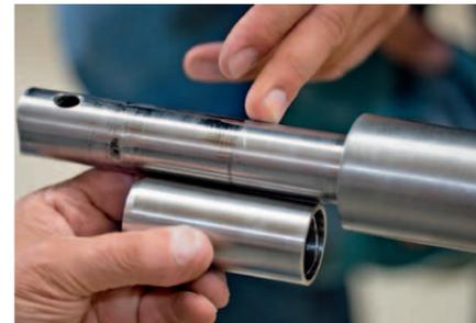
**3** **AUSGEMESSEN** Dazu werden zu den neuen Lagern passend angefertigte Edelstahlhülsen auf den Schaft geklebt. Die Tragspuren der alten Gleitlager dienen als Anhaltspunkt für die Positionierung; sicherheitshalber sollte aber genau ausgemessen werden →
